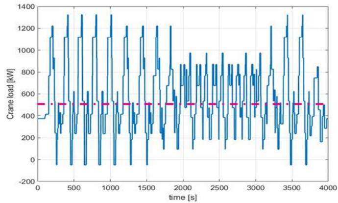
**FIG. 10.37: CRANE LOAD - FUNDAMENTAL CYCLE**
